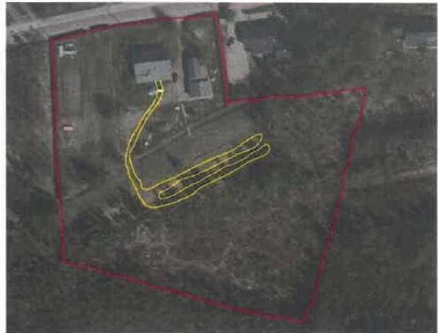
Kuva 7. Kiinteistön maalämpöjärjestelmän lämmönkeräysputkien likimääräinen sijainti ilmavalokuvaan piirrettynä.
