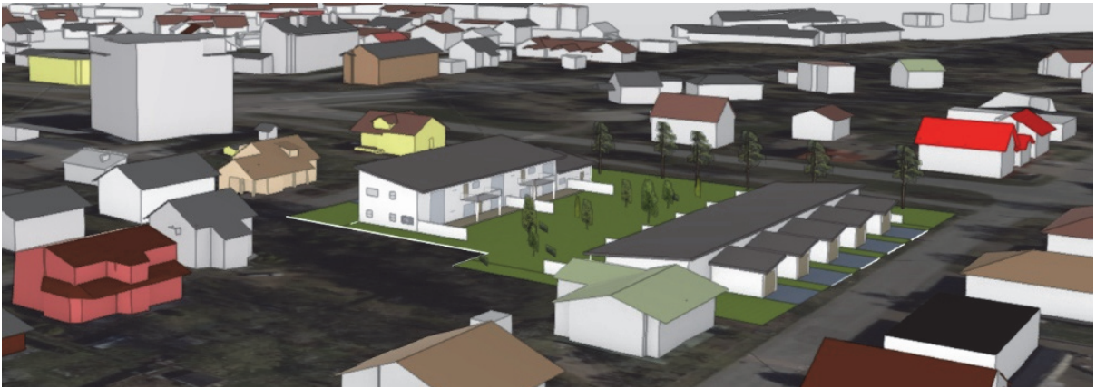
Kuva 7. Esimerkki A kaavaehdotuksen mahdollistamasta rakentamisesta etelän suunnasta katsottuna. Ratkaisussa nykyinen Palomäenkadun puoleinen kookas puusto on säilytetty ja rakentaminen sijoitettu Soininpolun ja Sampsantien reunoille. Auton säilytyspaikat on sijoitettu kunkin asunnon edustalle. Rakentamisen määrä n. 1000 k-m 2 vastaa tehokkuuslukua e=0,21.
