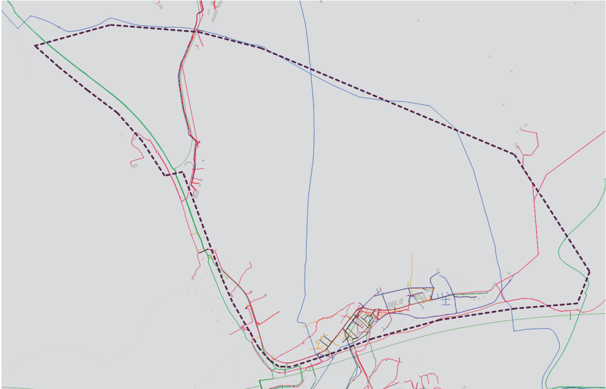
Kuva 8. Suunnittelualan johtokartta. Vesijohdot näkyvät kartassa sinisellä, sähköjohdot (ohut) ja maakaasu (paksu) punaisella, telekaapelit vihreällä, hulevesiputket keltaisella ja viemärit ruskealla värillä.
