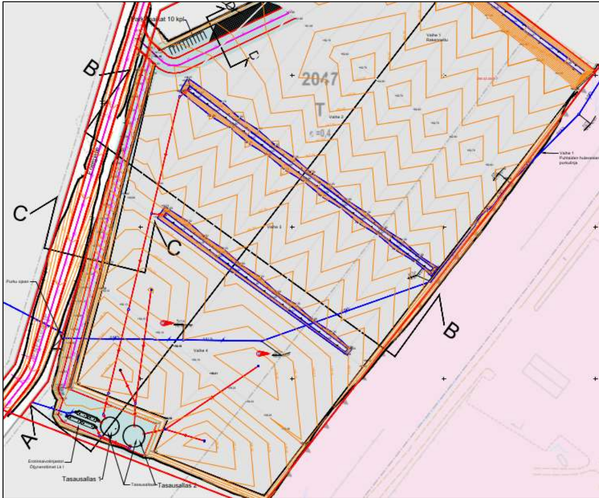
Kuva 12. Ote liitepiirustuksesta 107 D, jossa on esitetty vesien johtaminen. Punaiset viivat ovat tasausaltaisiin johtavia sadevesilinjoja ja sininen viiva puhtaiden hulevesien purkuoja ja putkilinja.
